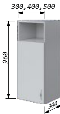
Шкаф глухой 30/40/50 с открытой полкой правый/левый Ширина -300/400/500мм Высота -960мм Глубина-300мм
